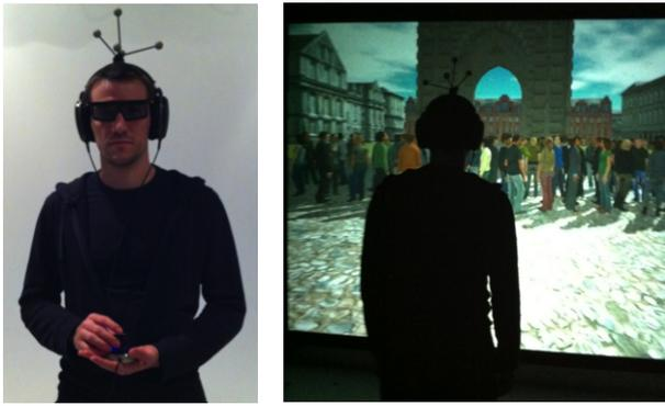
Dispositif de RV dans le studio 4 de l'Ircam. [à gauche] Le sujet porte des lunettes 3D, un casque audio ainsi que des marqueurs pour le système de suivi de position. Le sujet est équipé d'une souris 3D pour la navigation dans l'environnement virtuel. [à droite] Le sujet est immergé dans l'environnement virtuel et se trouve en face d'une foule virtuelle composée de 96 humanoïdes.
